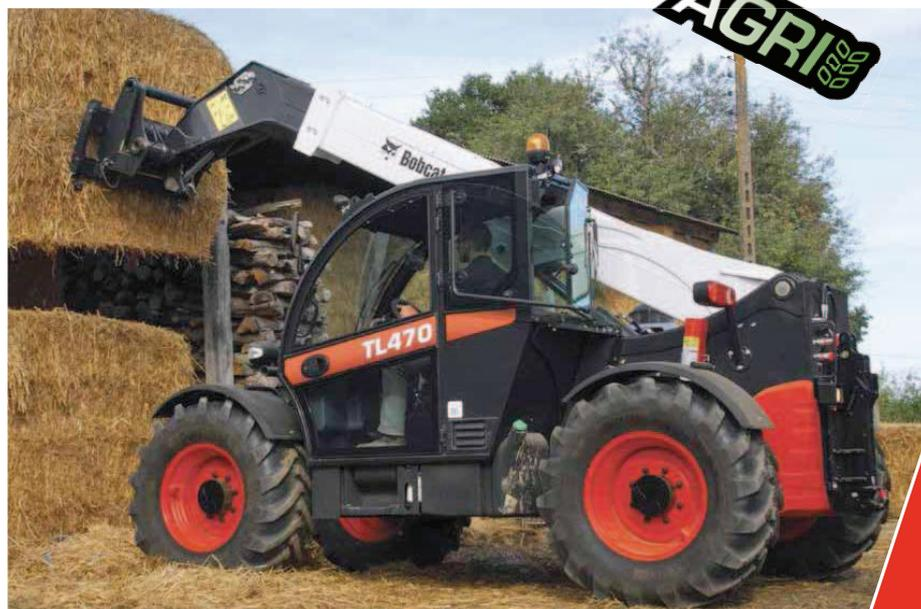
sponibilità operativa; tutti i punti di manutenzione sono infatti collocati in posizione di facile accesso come pure il motore che, montato lateralmente velocizza l'assistenza. La cabina asimmetrica è brevettata con profilo anteriore curvo offrendo così la massima visibilità panoramica sia in orizzontale che in verticale.
